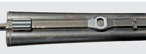
*Schritt 2:* Zunächst werden die Schieber des SEM-Schlösschens ausgebaut. Anschließend wird auf dem Schlösschengehäuse die Prismenplatte aufmontiert.
