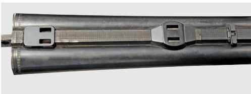
*Schritt 1:* Die SEM-Vorderplatte wird entfernt und durch eine passende Platte für Schwenkmontagen ersetzt. Wie es bei der SEM gemacht wurde, wird auch die neue Platte eingepasst und eingetrieben – Löten o.ä. ist nicht erforderlich.
