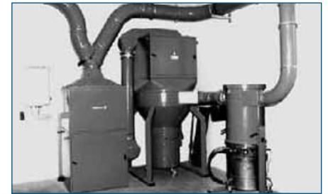
Absauganlage für Schleifstäube Extraction system for wheel dust Aspiration de poussière de meulage
